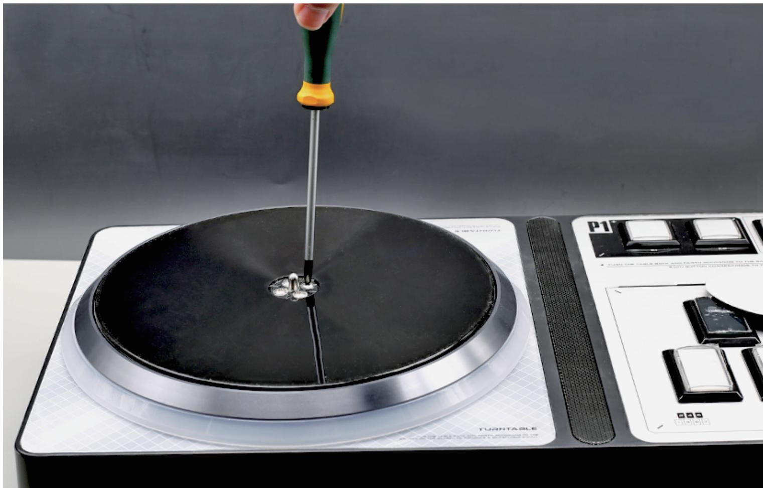
【20】 片手で片方のエッジを押し、もう一方の片手で反対側の隙間から皿を取り出してください。
