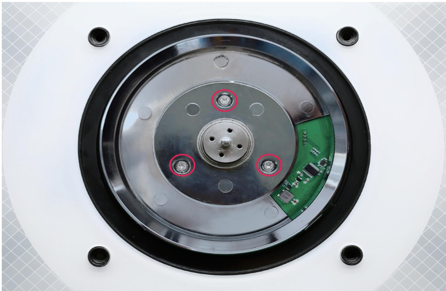
【28】 ネジを外して、古いリングライトを外します。
