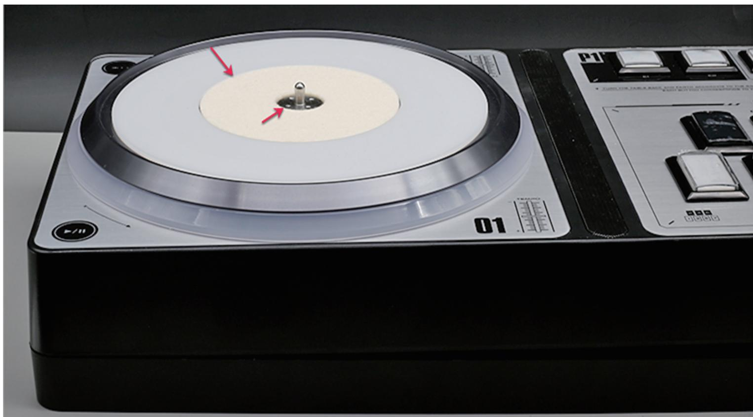
【37】 皿を元の場所に戻して、ネジを締めます。
